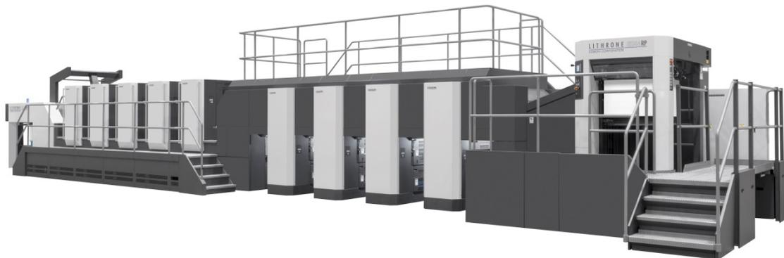
GLX-944RP(配置有印刷质量检测装置PQA-S、以及44英寸联机上光装置的九色单张纸胶印机)
